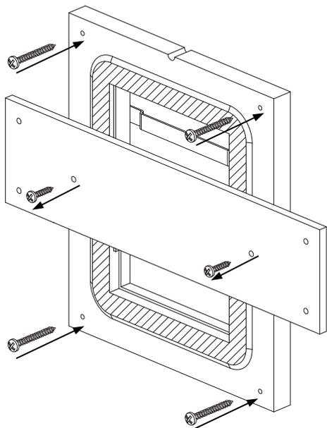
**4** Réalisez les travaux de plâtrage en évitant la *surface affleurante*. Une fois sec, vous pouvez effectuer les travaux de peinture et de finition du mur (en évitant de peindre la *partie intérieure de l'accessoire*).
