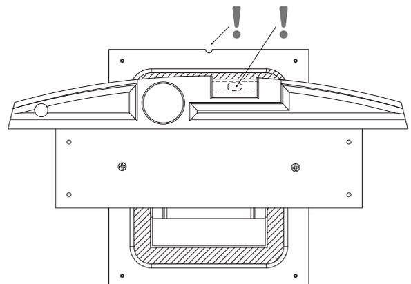
**3** Fixez l'accessoire aux guides de mur au moyen des vis adéquates (non incluses). Une fois fixée, vous pouvez retirer la *pièce auxiliaire de montage* avec ses quatre vis.
